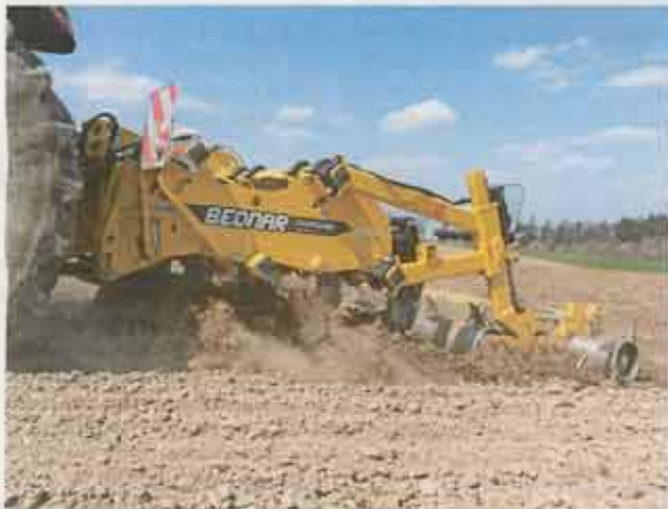
Dlátové pluhy TERRALAND TN sú známe s využitím radlíc ACTIVE-MIX a zadnými hrotovými valcami.
