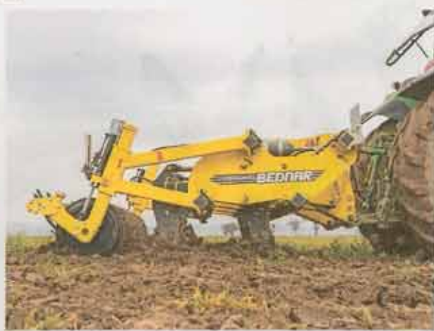
Múdre agronomické riešenie však umožňuje tento stroj osadiť ZERO-MIX radlicami a zadným Cutpack pechom na podryvanie.
